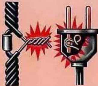
Поврежденная изоляция, неисправная электропроводка
